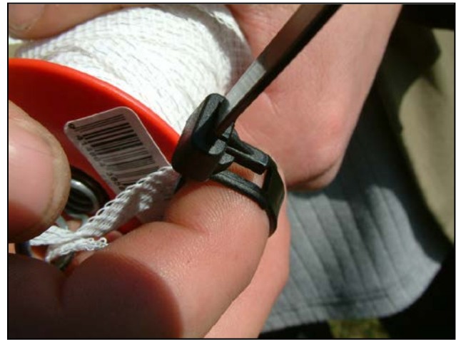
10.) Kabelbinder zumachen bis er ein Finger umschließt ( dies erleichtert das spätere Öffnen)
