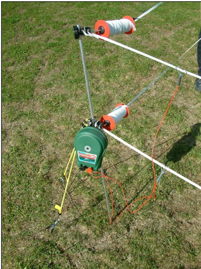
19.) Grünes bzw. schwarzes Erdkabel an schwarze Rändelmutter anschließen. Das andere Ende an den möglichst tief in den Boden gesteckten Hering anklammern
