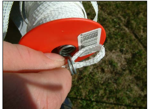
8.) Schlaufe durch Öse schieben
