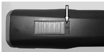
Fig. 4 Brytare i läge FRÅN ("0")
