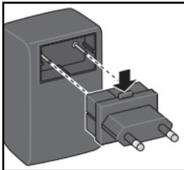
1. Pulse la tecla de desbloqueo **8** mientras extrae el adaptador de enchufe **9** montado.
