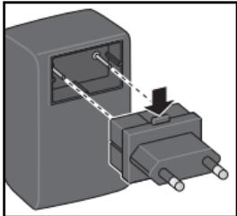
1. Drücken Sie die Entriegelungstaste **8** hinein, während Sie den montierten Netzstecker-Adapter **9** abziehen.
