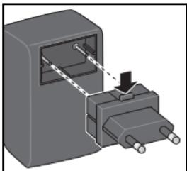
1. 取り付けられている電源プラグアダプター 9 を取り外しながら、ロック解除ボタン 8 を押します。
